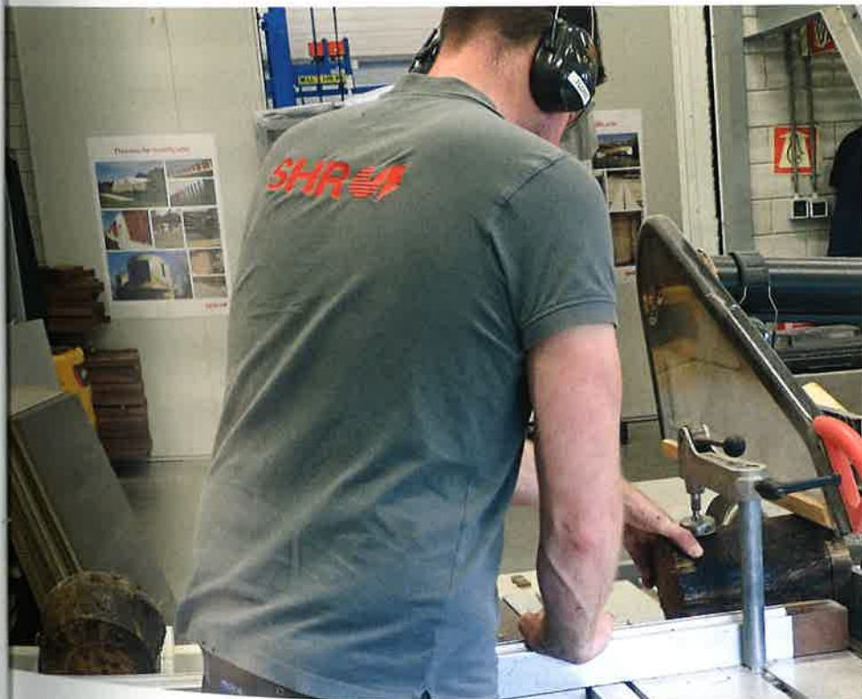
◀▲ Het boren van gaten in de paalstukken voor het plaatsen van sensoren.
