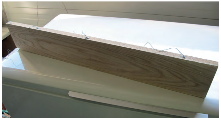
Proefstuk eiken met ingebrachte sensoren.
