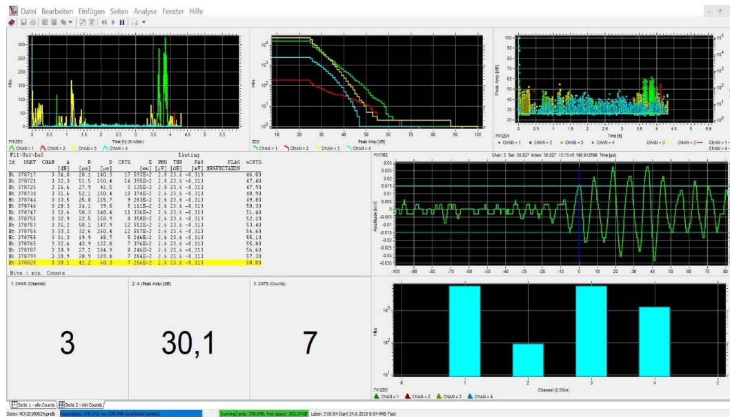
Abb. 2: Ergebnis einer 4 stündigen Messung für die 4 Proben in Abb. 1; farbliche Zuordnung wie Abb. 1
