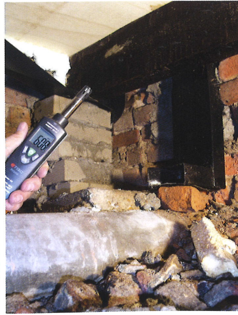
Onderzoek kruipruimte: meting van relatieve luchtvochtigheid. Foto: Van Lierop B.V., Alphen aan den Rijn
