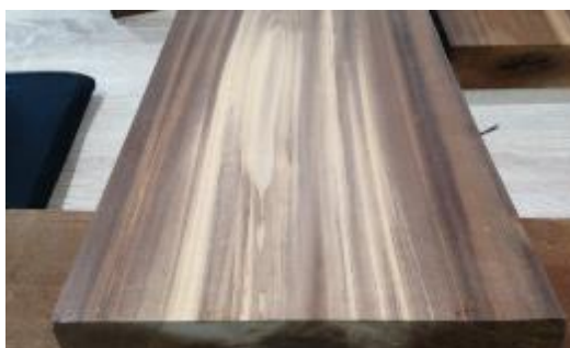
Figuur 29. Onvolledige modificatie behandeling van een populieren plank
