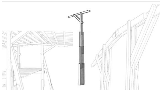
Figuur 28. Open construeren toren Panoramaheuvel (Ro & Ad architecten)
