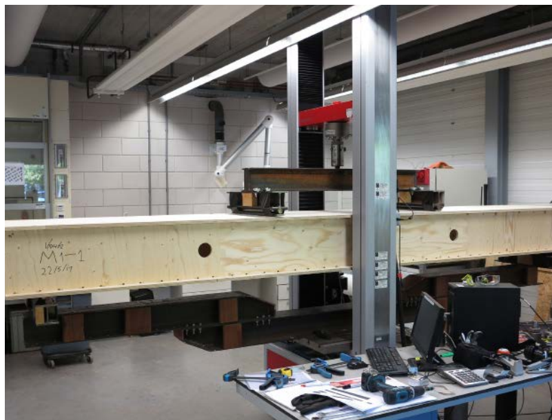
Opstelling van de vierpunts-buigproef.
