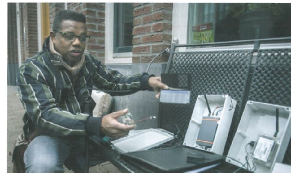
RFID-technoloog Rudolf Renfurm. "De onderhoudssensor bestaat eigenlijk uit een sensor met chip (in zijn rechterhand, red.), een gateway (kastje links op de bank) en een slimme router (kastje rechts)
