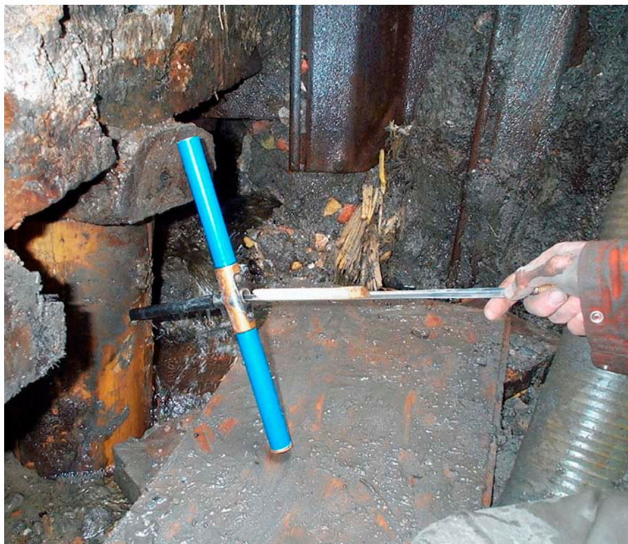
Houtmonstername uit een heipaal met een aanwasboor.
