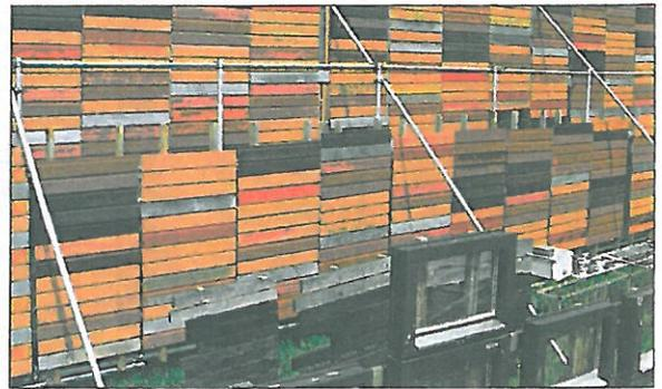
Testbereich für die Außenwitterung von Holz und Holzprodukten
