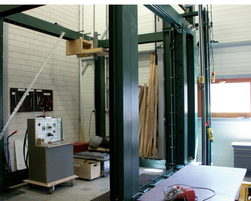
Inbraakopstelling in het testlaboratorium van het CB&V.
