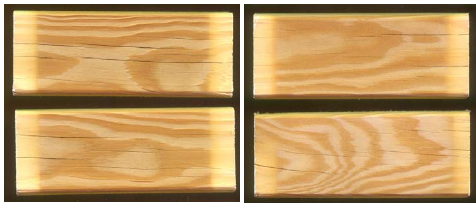
scheuren en verkleuring na snelverwering in niet gewaterd grenen (stam 2)
