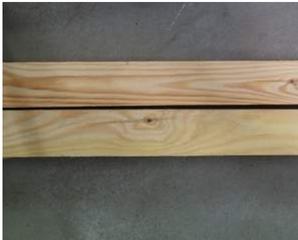
foto kleurverschil door wateren (onder gewaterd)
