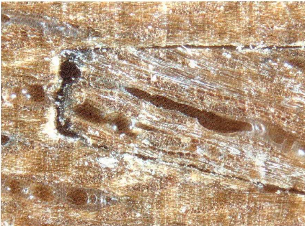
Microscopische foto van sapeli mahonie vingerlas waarbij de meeste lijm is weggeslagen (zichtbaar in de houtvaten).
